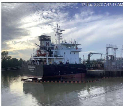
ภาพที่ 2-6 การล้อมทวน (Boom) รอบลำเรือบรรทุกน้ำมัน
