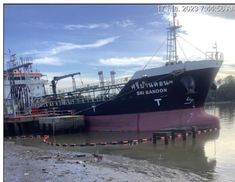
ภาพที่ 2-6 การล้อมทวน (Boom) รอบลำเรือบรรทุกน้ำมัน
