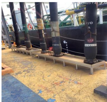
ภาพที่ 2-8 ถาดรองน้ำมันที่อาจรั่วหกและวาล์วที่ปิดกั้นน้ำมันปิดตลอดเวลาการขนถ่ายน้ำมันที่ทำ
